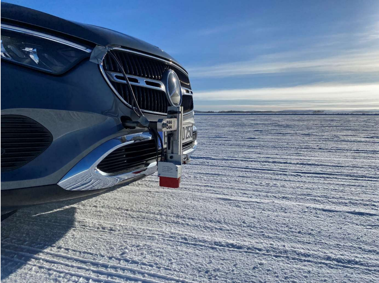
Abbildung 2: Der OMS 7-Sensor montiert an der Abschleppöse eines Mercedes
